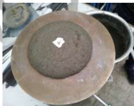
(d) Mortar test for AC-FA 50
