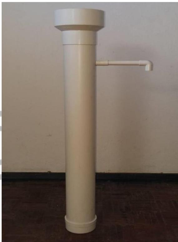
**Figura 3. 2** - Estrutura do filtro de DN110
