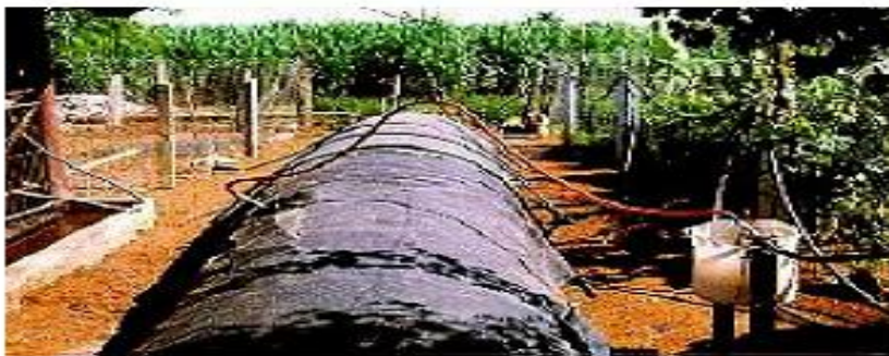
Figura-1.16- Biodigestor do tipo tubular de polietileno.(lizandra,2014)
