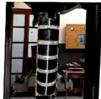
Fig4.7(d) CRC(FRP+PVC) Column
