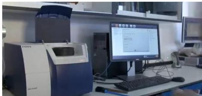
*Figure 5: NIRS™ DS2500 F integrated with a PC .*
