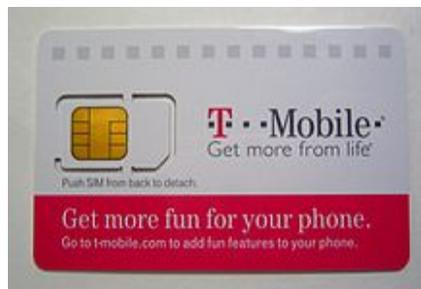
Carte SIM livrée au format carte de crédit par l'opérateur T-Mobile. La partie centrale se détache pour pouvoir être insérée dans le téléphone.
