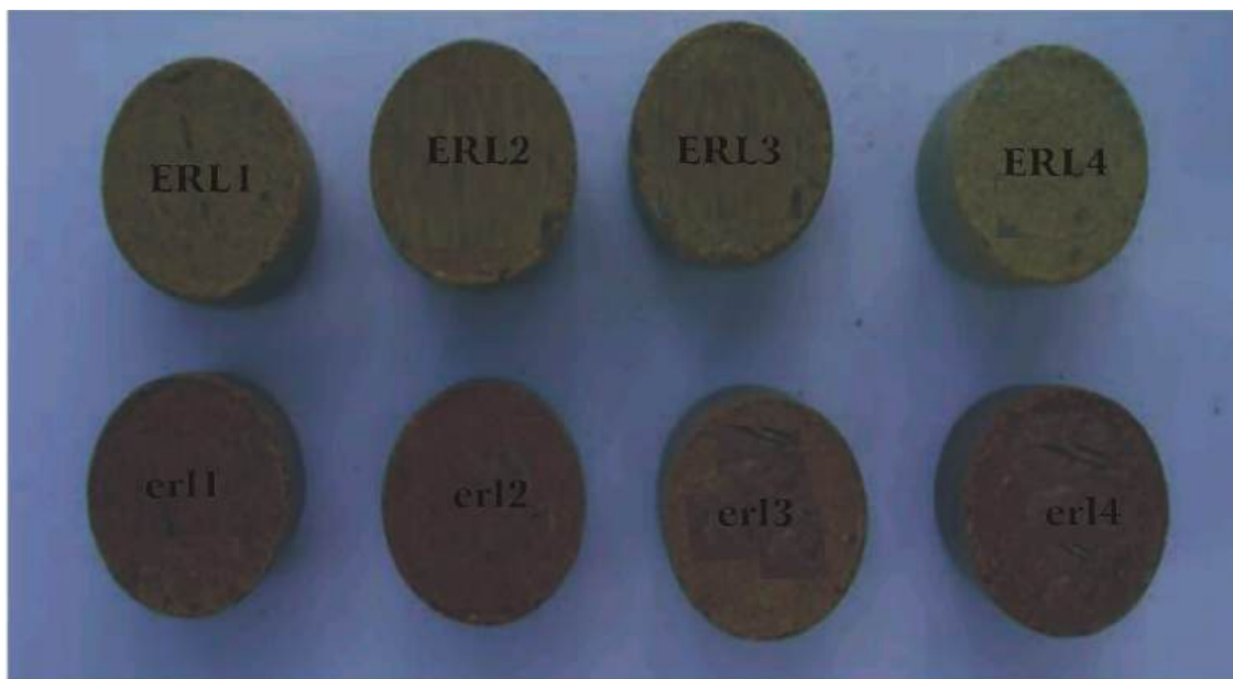
Figure 4.11: Colour change of clay samples before (erl1, erl2, erl3, erl4) after firing, (ERL1, ERL2, ERL3, ERL4)
